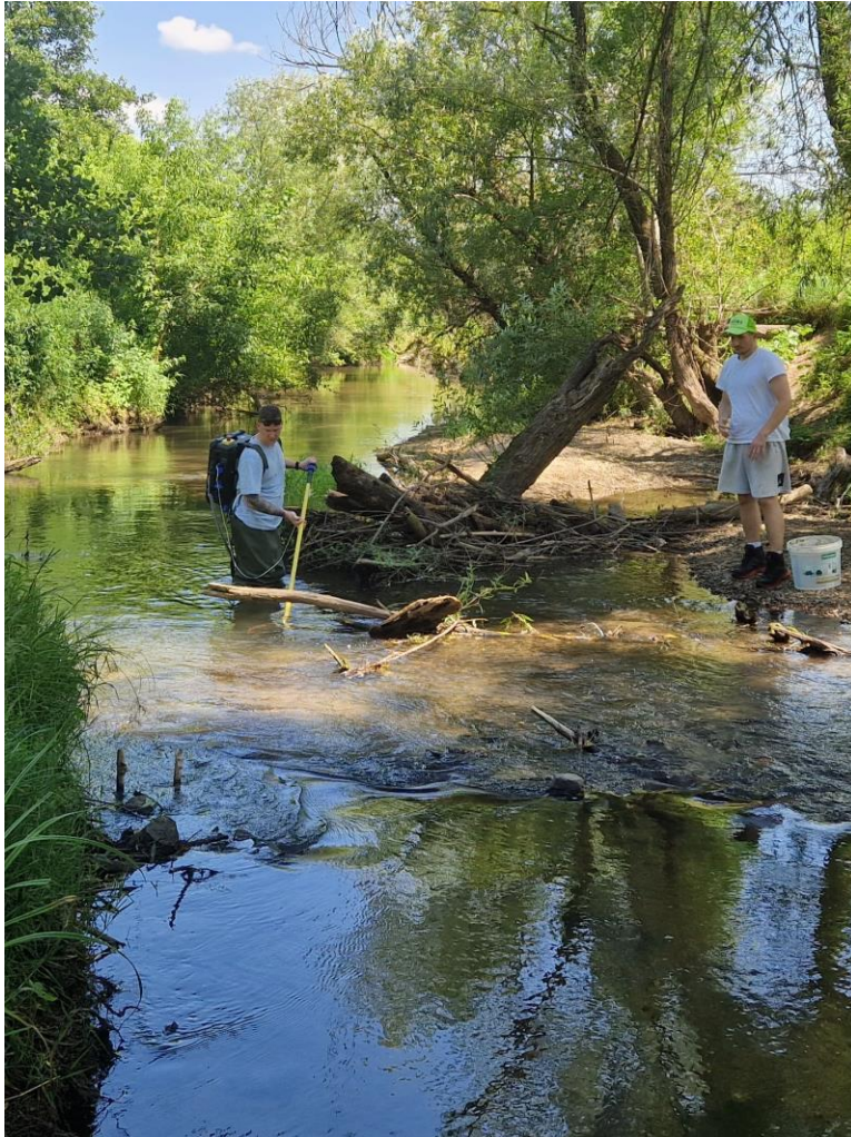
Slika 8 Uzorkovanje ihtiofaune elektroribolovom pomoću lednog agregata
